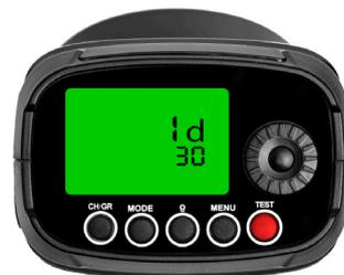
**Nota:** il trasmettitore funziona come Master, mentre ProLight T200 TTL funziona come Slave. Per poter accoppiare il ProLight T200 TTL e il trigger è necessario impostare entrambi sullo stesso canale ed ID.
