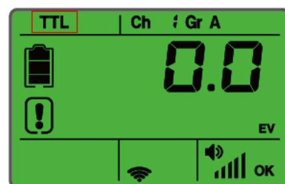
**Compensazione Esposizione Flash (FEC):** il parametro FEC è regolabile entro un range di +3 e -3, con un incremento di 1/3 di stop. La funzione FEC è utile per effettuare correzioni dell'esposizione automatica del flash ed ottenere l'esposizione desiderata.
