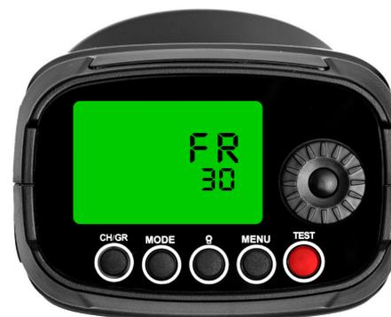
**Attenzione:** per prevenire danneggiamenti del flash dovuti a surriscaldamento, utilizzare la funzione MULTI per non più di 10 scatti, poi farlo raffreddare per 15 minuti. Se si attiva la funzione di protezione dal calore, lasciarlo raffreddare per 30 minuti.
